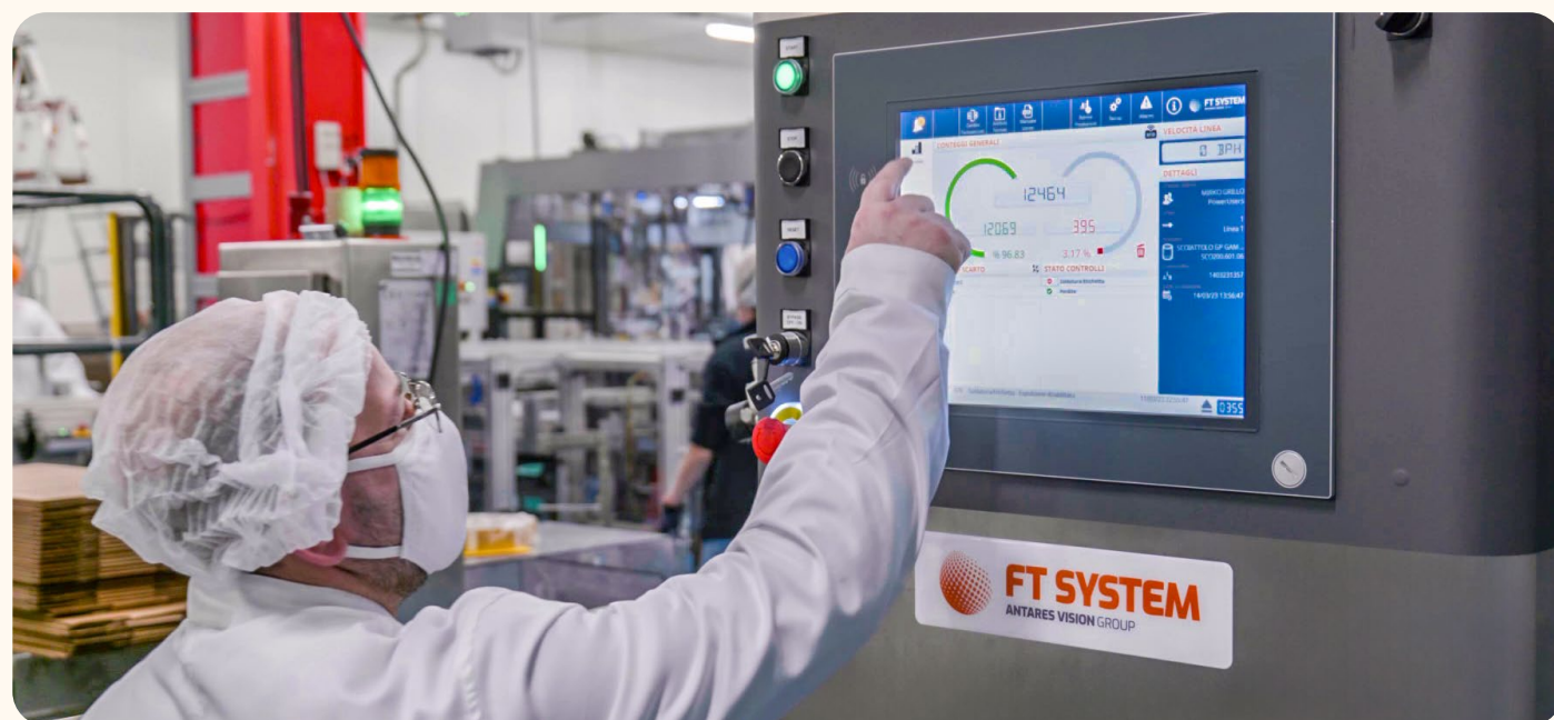
Utilizzo della tecnologia Antares per il controllo di eventuali non conformità dei pack
